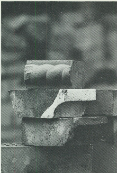
Rester av Minnesbergs stolta produktion av formtegel, funna intill tegelbruket. Överst en del av en repstav, därunder en vitglaserad hälkälssten och underst en karnisformad konsolsten. Foto förf. 1982.
