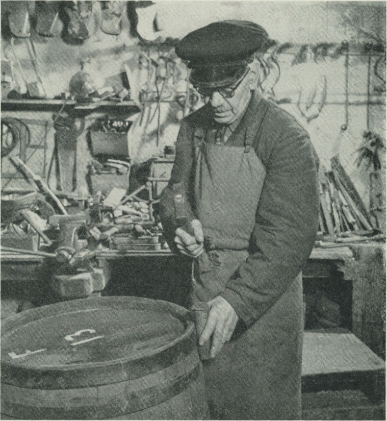
Med "drivning" och hammare slås banden ned. I bakgrunden skymtar arbetsbänken med skruvstycke och mängder av verktyg — bandknivar, "krösar", "spockskivor", "studsare" m. m.
