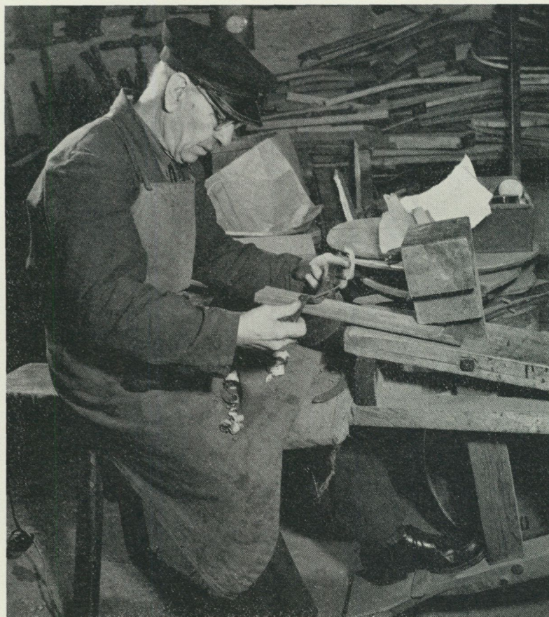
Tunnbindare Ernst Cederholm på skärbänken, "kärings", visar hur insidan av "staven" skärs till med en krumkniv.
