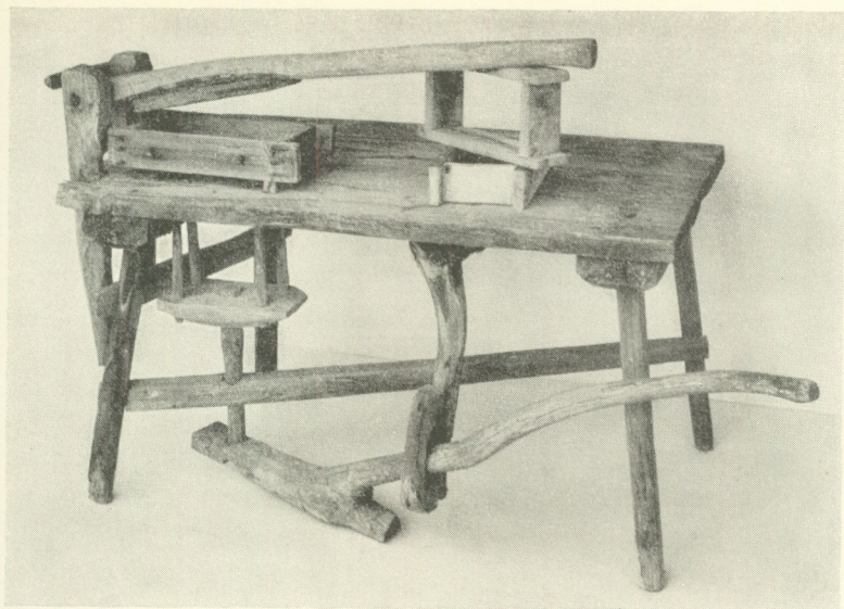
Bild 1. Tegelpress från Bjursås socken, Dalarna. Användes sista gången för ett fyrtiotal år sedan. Nordiska museet 199,274.
